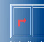
2-teiliges Element mit Hebe-Schiebeflügel und Festverglasung
